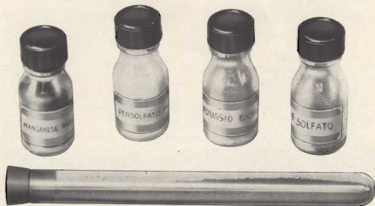
Fig. 3 - Ingredienti chimici necessari alla realizzazione delle pile a carta.
