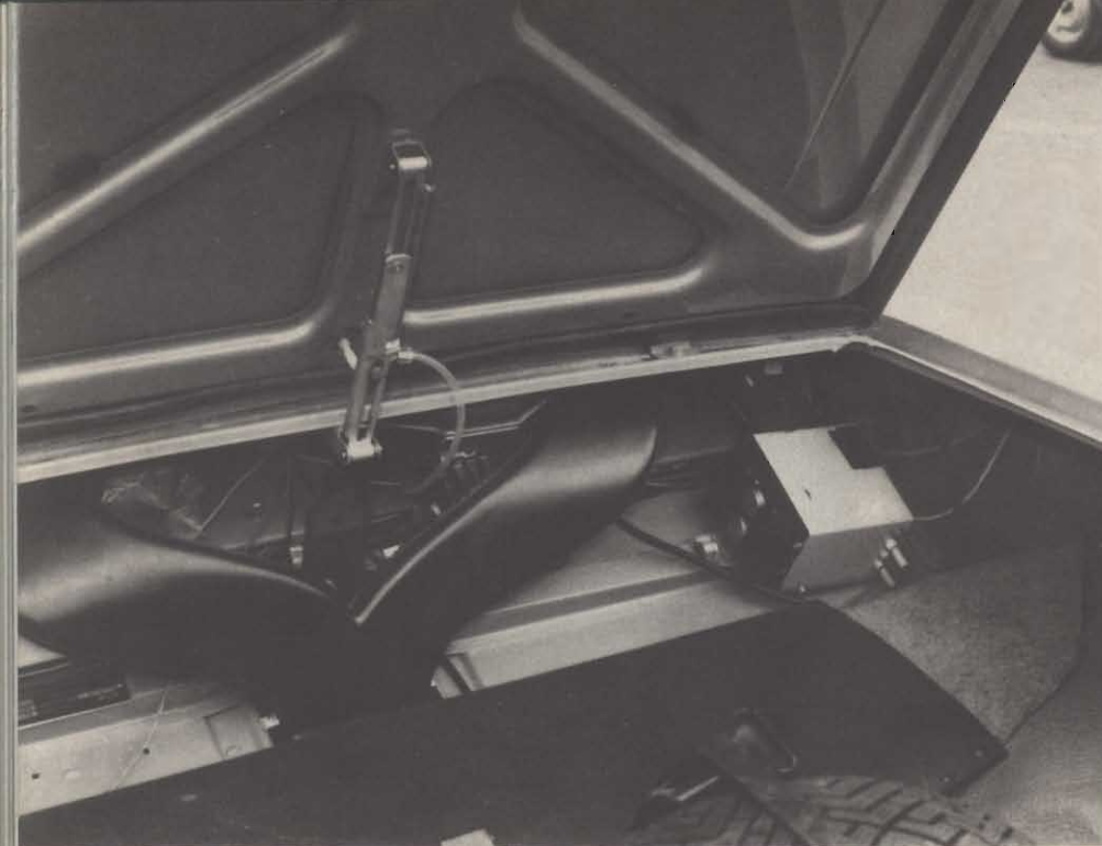
Fig. 7 - Foto illustrante la posizione nella quale il dispositivo è stato installato nel vano anteriore portabagagli, in una vettura di tipo NSU-1200 TT.
