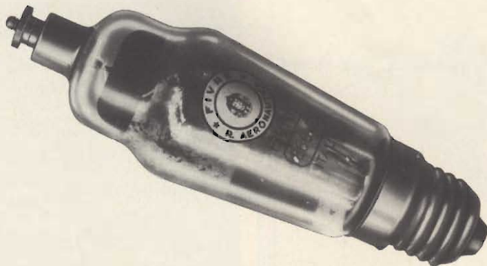
Fig. 6 - Diodo rettificatore a vapori di Mercurio tipo 866-E. Costruito dalla FIVRE per l'Aeronautica Italiana nel 1939/40.
